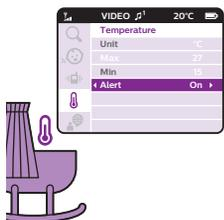
3 Zvolením možnosti výstrahy teploty výstrahu zapnete. Chcete-li změnit maximální a minimální teplotu pro teplotní výstrahu, zvolte požadované hodnoty teploty pro položky nabídky „Max“ a „Min“.
