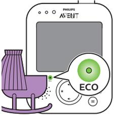
Kad je aktiviran način rada ECO, zaslon i zvuk roditeljske jedinice isključit će se ako se tijekom 20 sekundi ne otkrije zvuk. Indikator ECO zasvijetli zeleno kako bi se naznačilo da je aktiviran način rada ECO, prijenos prikaza i zvuka je isključen.
