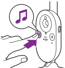
За да активирате функцията за приспивна песен от устройството за бебето, натиснете бутона за включване/изключване на приспивна песен на устройството за бебето.
