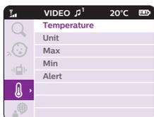
Tip: Pomocí možnosti nastavení jednotek můžete přepínat mezi stupni Celsia (°C) a Fahrenheita (°F).
