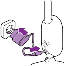
Csatlakoztassa a hálózati adaptert a bébiegységhez, majd csatlakoztassa az adaptert a fali konnektorba.
