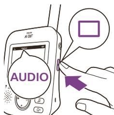
Quando o modo ÁUDIO estiver ativado, a tela da unidade dos pais ficará desligada. Após 3 segundos, o visor ficará totalmente desligado e a barra de status desaparecerá.
