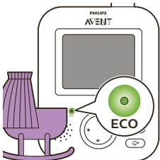
Quando o modo ECO estiver ativado, a tela e o som da unidade dos pais ficarão desligados se nenhum som for detectado por 20 segundos. A luz ECO se acende em verde para indicar que o modo ECO está ativado. Durante o modo ECO, o visor e transmissões de som estarão desligados.
