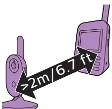
**Poznámka:** Ak používate bezdrôtový telefón, bezdrôtové video zariadenie, sieť Wi-Fi, mikrovlnnú rúru alebo rozhranie Bluetooth pracujúce na frekvencii 2,4 GHz a rodičovská alebo detská jednotka vykazuje známky rušenia, rodičovskú jednotku premiestňujte, kým sa rušenie nestratí!
