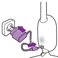
Sieťový adaptér zapojte do detskej jednotky a potom do elektrickej zásuvky.
