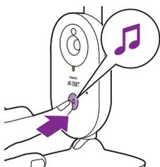
Aby aktywować funkcję kołysanki z nadajnika, naciśnij włącznik kołysanki na nadajniku.
