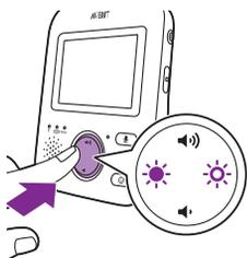
Istnieje możliwość regulacji jasności wyświetlacza odbiornika.
