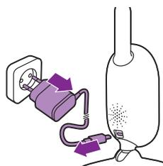
1 Izklopite otroško enoto ter iz nje in iz zidne vtičnice iztaknite napajalnik.
