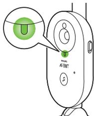
2 Keď je detská jednotka zapnutá, kontrolné svetlo napájania na detskej jednotke svieti na zeleno.
