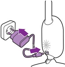
Włóż wtyczkę adaptera zasilania w nadajniku i podłącz zasilacz do gniazdka elektrycznego.
