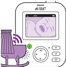
Kada jedinica za bebu zabeleži neki zvuk, ekran i zvuk na roditeljskoj jedinici se odmah uključuju. Zvukovi se prenose na roditeljsku jedinicu.
