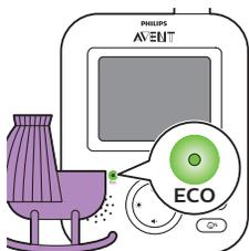
Po aktywowaniu trybu ECO wyświetlacz i dźwięki odbiornika są wyłączone, jeśli przez 20 sekund nie zostanie wykryty żaden dźwięk. Jeśli wskaźnik ECO świeci na zielono, oznacza to, że tryb ECO jest aktywny. W trybie ECO transmisja obrazu i dźwięku jest wyłączona.
