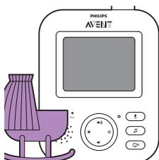
Po aktywowaniu trybu VOX, wyświetlacz i dźwięki odbiornika są wyłączane, jeśli przez 20 sekund nie zostanie wykryty żaden dźwięk.
