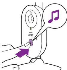
Če želite na otroški enoti vklopiti funkcijo za uspavanke, na njej pritisnite gumb za vklop/izklop uspavanke.
