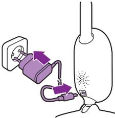
Priključite adapter za napajanje u jedinicu za bebu i uključite adapter u zidnu utičnicu.
