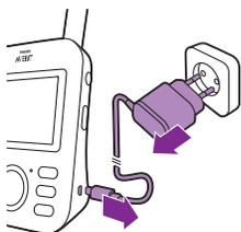
3 Izklopite starševsko enoto ter iz nje in iz zidne vtičnice iztaknite napajalnik.
