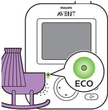
Ja ir aktivizēts režīms ECO un 20 sekunžu laikā netiek uztverta nekāda skaņa, tiek izslēgts vecāku ierīces displejs un skaņa. Režīma ECO indikators iedegas zaļā krāsā, norādot, ka ir aktivizēts režīms ECO. Kad ir aktivizēts režīms ECO, displejs un skaņas pārsūtīšana ir izslēgti.
