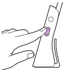
Gdy elektroniczna niania jest włączona, możesz przełączać pomiędzy 4 różnymi trybami, naciskając przycisk trybu z boku odbiornika.
