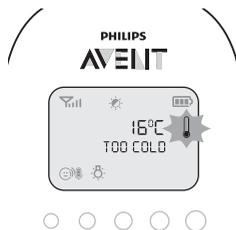
Ako je temperatura ispod ili iznad podešenog opsega, simbol alarma za temperaturu na ekranu će imati samo jedan segment i treperiće. Na displeju će se pojaviti poruka „TOO COLD“ (Prehladno) ili „TOO HOT“ (Pretoplo).
