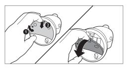
2 Coloque quatro pilhas alcalinas não recarregáveis.
