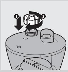
**5** Закройте резервуар крышкой (1) и поворачивайте ее по часовой стрелке (2) до тех пор, пока она не закроется плотно.
