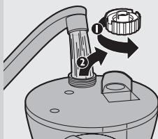
**4** Обърнете водния резервоар с дъното нагоре. Завъртете запушалката на резервоара обратно на часовниковата стрелка, за да я отворите (1), и напълнете резервоара с около 2 литра чиста вода (2).
