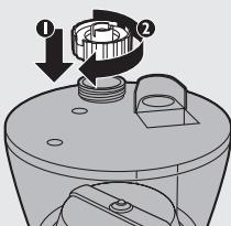
**5** Vratite poklopac na spremnik za vodu (1) i okrećite ga u smjeru kazaljke na satu (2) dok ne bude čvrsto pričvršćen.
