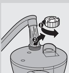
**4** Переверните резервуар вверх дном. Поверните крышку резервуара против часовой стрелки, чтобы снять ее (1), затем заполните резервуар водой (около 2 литров) (2).
