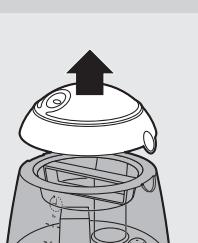
**1** Убедитесь, что увлажнитель воздуха отсоединен от электросети, и регулятор подачи водяного пара установлен в положение off (выкл.).
