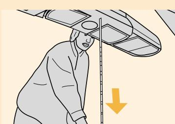
Вы можете проверить высоту установки прибора, вытянув рулетку.
