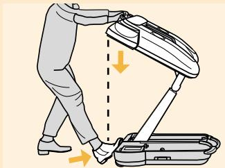
Система автоматического снятия блокировки сработает только после того, как вы достаточно откинете назад верхнюю часть прибора вместе со стойкой. Однако при этом следует соблюдать осторожность: в противном случае, вы можете потерять равновесие.
