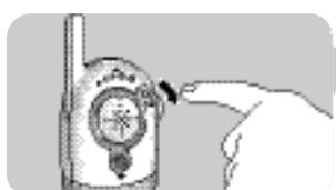
3 Slå på foreldreapparatet med AV/PÅ-bryteren (B-9) og juster volumet til det nivået du foretrekker, med VOLUM-kontrollen (B-9).
