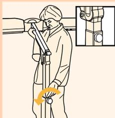
**3** Țineți ferm porțiunea superioară a suportului cu o mână și deșurubați butonul de reglare a înălțimii (A) răsucindu-l în sens invers acelor de ceasornic.
