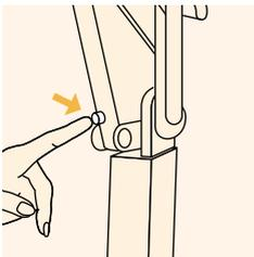
Het apparaat ontgrendelt niet automatisch. In dat geval moet u eerst op ontgrendelknop (B) drukken, waarna u het apparaat terug in de transportstand kunt klappen op de manier die beschreven staat in het hoofdstuk 'Opbergen'. Als het apparaat verscheidene keren weigert automatisch te ontgrendelen, neem dan contact op met uw dealer of met een Philips servicecentrum.
