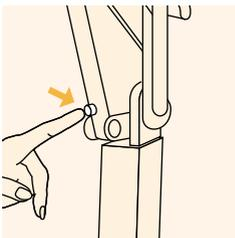
L'appareil ne se déverrouille pas automatiquement. Appuyez sur le bouton (B) de déverrouillage, puis mettez le solarium en position de transport comme il est indiqué au chapitre "Rangement". Si ce dérangement se produit plusieurs fois, nous vous conseillons de faire appel à votre distributeur ou à un Centre Service Agréé Philips.
