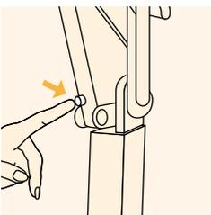
Das Gerät entriegelt nicht automatisch. In diesem Fall müssen Sie zunächst die Entriegelung (B) drücken. Anschließend können Sie das Gerät, wie im Kapitel "Aufbewahrung" beschrieben, in die Transportposition zusammenklappen. Haben Sie häufiger Probleme mit der Entriegelung, setzen Sie sich mit Ihrem Händler oder einem Philips Service-Center in Verbindung.
