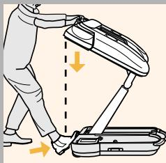
**9** Задвиньте верхнюю часть прибора.
