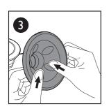
4 将硅胶隔膜放入主体,用手指按 压, 使边缘牢牢扣紧, 确保完全 密封。
