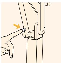
Aparat se automatski ne otključava. U tom slučaju prvo morate pritisnuti gumb za otključavanje (B), nakon čega možete sklopiti aparat natrag u položaj za transport na način prikazan u poglavljju "Pohranjivanje". Ako se aparat nekolicu puta ne otključa, obratite se prodavaču ili Philipsovom servisnom centru.
