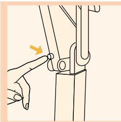
Aparat se ne odklene samodejno. V tem primeru morate najprej pritisniti odklepni gumb (B), šele nato lahko sklopite aparat nazaj v transportni položaj v smislu prikaza v poglavju "Shranjevanje". Če se aparat večkrat ne more odkleniti, se obrnite na trgovca ali pooblaščeni Philipsov servisni center.
