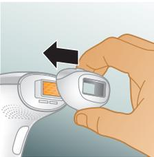
Pour monter un accessoire, il vous suffit de l'enclencher sur le verre filtrant.
