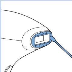
**Tip:** Als het niet meer mogelijk is de randen van de opzetstukken met het bijgevoegde reinigingsdoekje schoon te maken, gebruik dan in plaats daarvan een wattenstaafje. Controleer of geen pluisjes of vezels op de opzetstukken of op het lichtvenster achterblijven.
