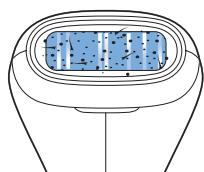
**Opmerking:** Een vervuild lichtvenster en/of opzetstuk kan eruitzien zoals op deze afbeelding. Maak het apparaat voor en na ieder gebruik schoon en indien nodig ook tijdens het gebruik, volgens de instructies in dit deel van de gebruiksaanwijzing.
