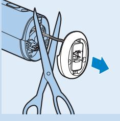
**3** Remova a parte inferior do cabo e corte os dois fios que conectam a parte inferior ao aparelho.
