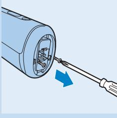
**2** Retire os dois parafusos da parte inferior do cabo usando uma chave de fenda.
