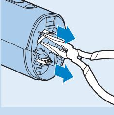
**4** Remova os conectores da bateria dos terminais com um alicate de ponta chata.
