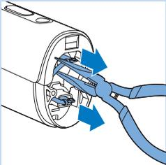
**6** Estraiete i connettori della batteria dai relativi terminali con delle pinze a becco lungo.
