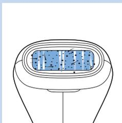
*Nota: Una finestra di emissione della luce e/o un accessorio contaminati possono apparire come nella figura. Effettuate la pulizia dell'apparecchio prima e dopo ciascun utilizzo e, se necessario, anche durante il trattamento, in base alle istruzioni di questa sezione.*
