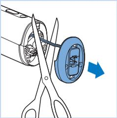
**5** Rimuovete la parte inferiore dell'impugnatura e tagliate i due fili che collegano la parte inferiore all'apparecchio.
