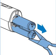
**7** Estraiete le batterie ricaricabili dall'apparecchio con delle pinze a becco lungo.
