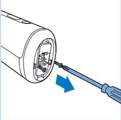
**4** Svitare le due viti nella parte inferiore dell'impugnatura con un cacciavite.
