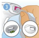
Controllate che l'accessorio e la finestra di emissione della luce siano puliti. In caso di sporco, pelli o fibre, puliteli prima dell'uso utilizzando il panno in dotazione.
