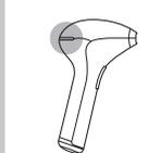
LED-ul "pregătit pentru pulsații" situat pe partea posterioară a aparatului se aprinde verde când toate întrerupătoarele de contact ale inelului de siguranță sunt în contact cu pielea iar aparatul este încărcat. Aceasta poate dura câteva secunde.
