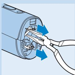
**4** Trennen Sie die Akkus mit einer Spitzzange von den Anschlüssen.
