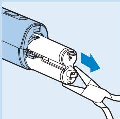
**5** Ziehen Sie die Akkus mit einer Spitzzange aus dem Gerät.
