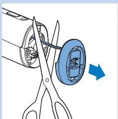
5 Vyjměte dolní část držadla a přestřihněte dva dráty, které spojují dolní část s přístrojem.
