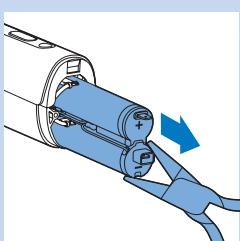
7 Úzkými plochými kleštěmi vytáhněte nabíjecí baterie z přístroje.
