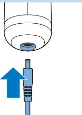
**2** Työnnä pieni liitin laitteeseen ja kytke latauslaite pistorasiaan.
