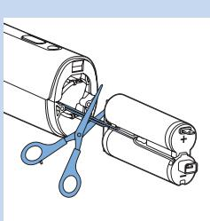
8 Kutt de to ledningene én om gangen for å sikre at det ikke skjer noen uhell på grunn av en mulig gjenværende lading.
