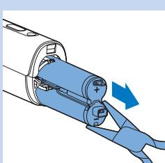
7 Trekk de oppladbare batteriene ut av apparatet med en lang nebbtang.
