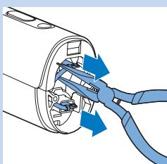
6 Trekk batterikontaktene av batteripolene med en lang nebbtang.
