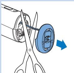
5 Fjern den nedre delen av håndtaket og kutt de to ledningene som forbinder den nedre delen til apparatet.
