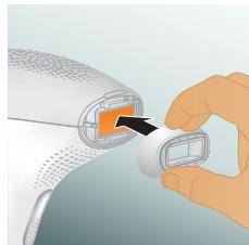
Za uklanjanje nastavaka izvucite ih s prozora za izlaz svjetla.
