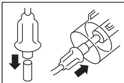
2. Conecte el tubo al compresor y al recipiente para el medicamento.
