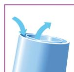
El efecto venturi permite que 6 litros de flujo producidos por el compresor se conviertan en 16 litros de salida (8 litros nos da 22 de salida).
