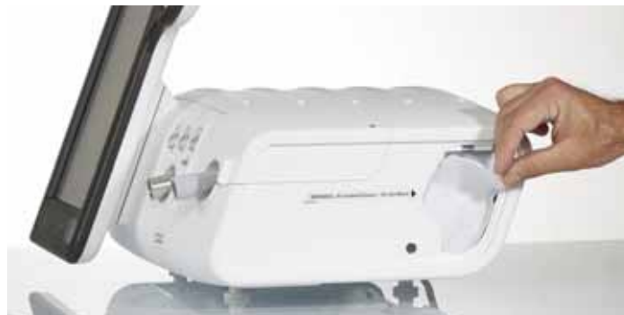
Abbildung 10-8: Ersetzen des Luftansaugfilters
