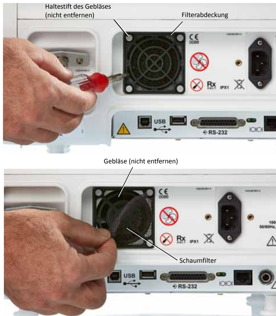
Abbildung 10-9: Ersetzen des Kühlgebläsefilters
