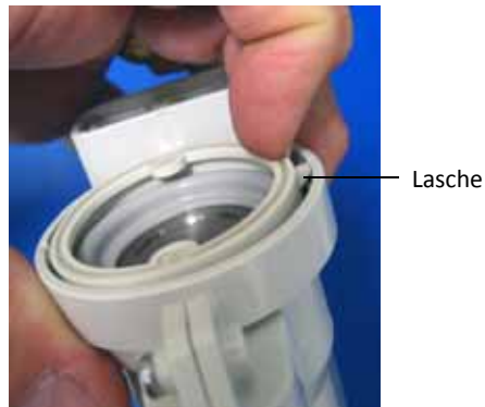
Abbildung 10-1: Abnehmen des Halterings
